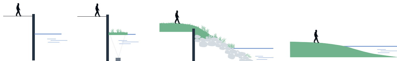
Hård kant, bygninger, eksisterende og udbedret spuns
